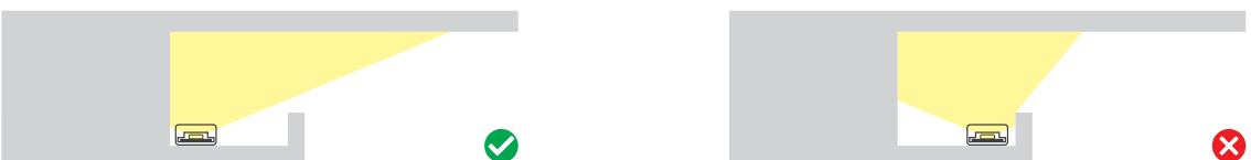
هنگام نصب ریسه در سقف کاذب رعایت فاصله درست
