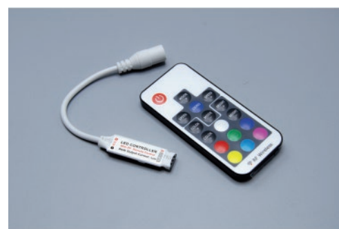
کنترلر RGB RF mini کنترلر رادیویی مینی (RF) لوپ لایت برای ریسه‌های ۱۲ ولت RGBLine DC 12V
